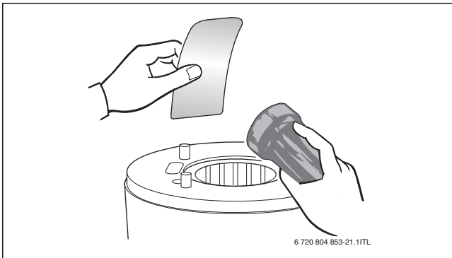
Bild 45 Wärmeblock auf Rückstände prüfen
